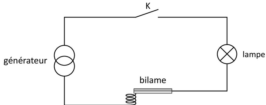
La lampe a les caractéristiques (6 V ; 12 W). L'épaisseur du bilame est  $d = 0,2$  mm, sa résistance vaut  $0,8 \Omega$  et sa capacité thermique est  $1,6$  J/K. Le générateur délivre un courant constant de sorte que la tension aux bornes de la lampe soit 6 V.
