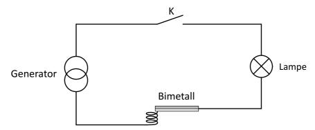
Die Lampe hat die Eigenschaften (6 V ; 12 W). Die Dicke des Bimetalls beträgt  $d=0.2~\mathrm{mm}$ , sein Widerstand beträgt  $0.8~\Omega$  und seine Wärmekapazität ist  $1.6~\mathrm{J/K}$ . Der Generator liefert einen konstanten Strom, so dass die Spannung an der Lampe  $6~\mathrm{V}$  ist.
